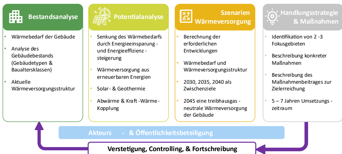
Abbildung 1: Ablaufplan kommunale Wärmeplanung (normales Verfahren)
